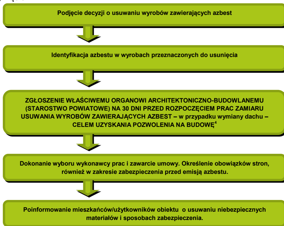
Rysunek 4. Schemat procedury dotyczącej obowiązków i postępowania właścicieli i zarządców przy usuwaniu wyrobów zawierających azbest z obiektów i terenów zlokalizowanych na terenie Gminy Dąbie
